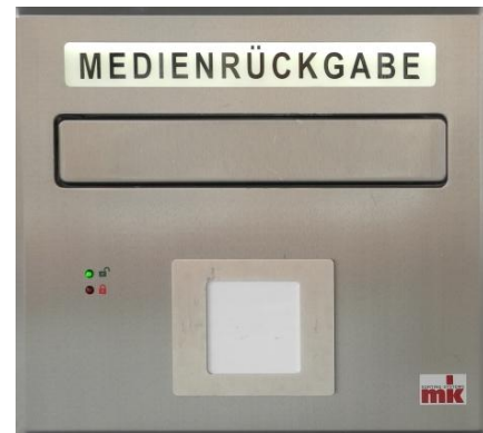
Foto: Margarete Timme Unter dem Schriftzug ist die Klappe durch die das Medium geschoben wird. Darunter das Feld, das die Informationen des Transponderetiketts liest.
